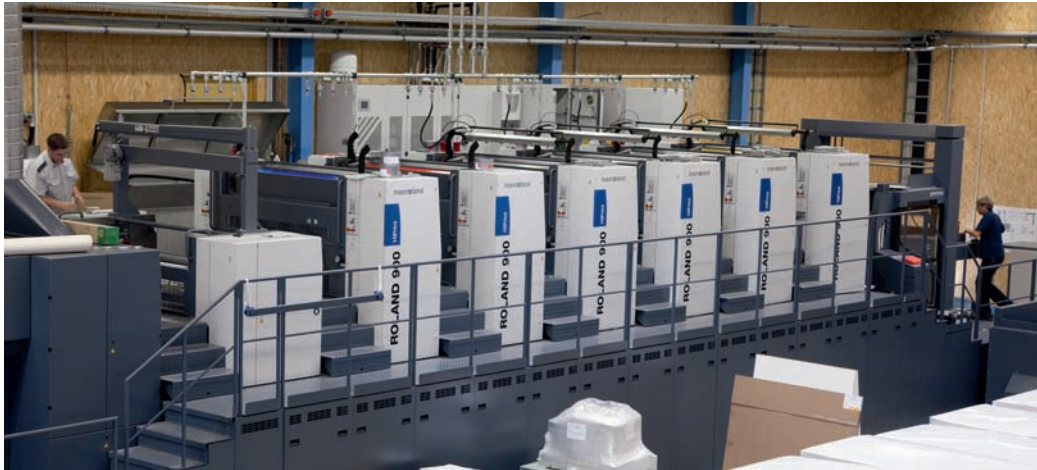
Links: Mit der Roland 900 steigt das traditionelle Flexodruckunternehmen in den großformatigen Offsetdruck ein. Rechts: Ein wesentliches Kriterium war für die Geschäftsführer von Wenner auch ein lückenloses, vollautomatisches Logistik-System, hier das Aupasys.
